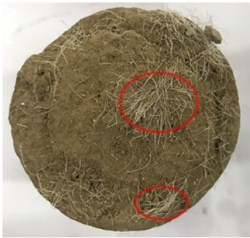
图 3 纤维在试样中的分布 Fig.3 Distribution of fibers in the specimen
